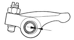
Fig. 27. Clearance rocker - rocker shaft
